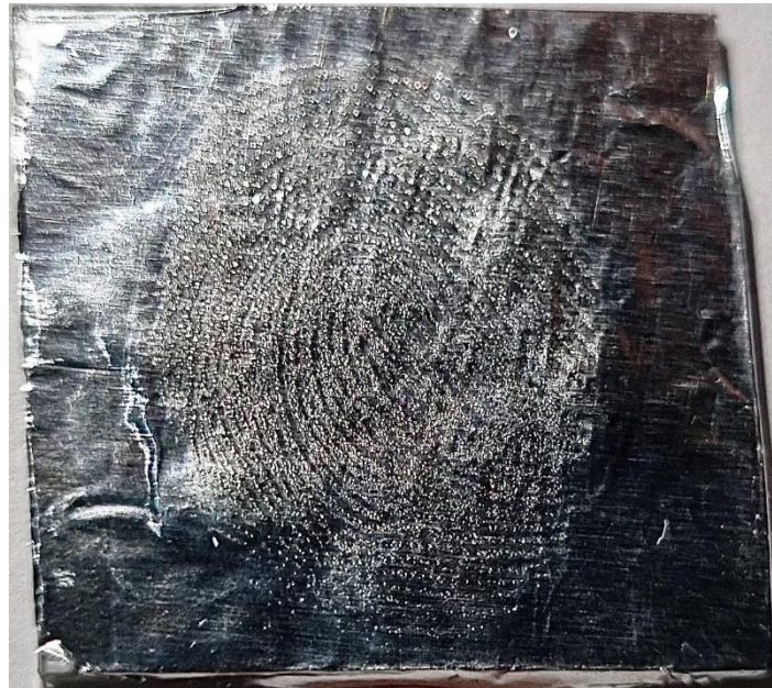
Figura 10 - Exemplo de substrato utilizado na coleta de impressões digitais. É possível identificar a presença de uma impressão depositado sobre a lâmina de alumínio.
