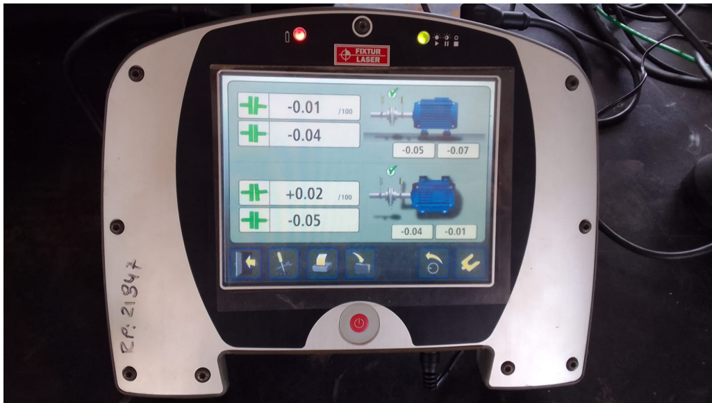
Figura 37 – Informação da bancada alinhada pelo equipamento de alinhamento.
