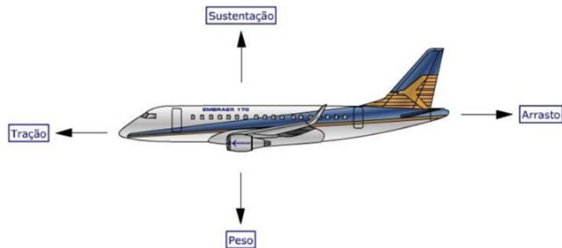
Figura 4 – Figura de equilíbrio de forças em uma aeronave em cruzeiro
