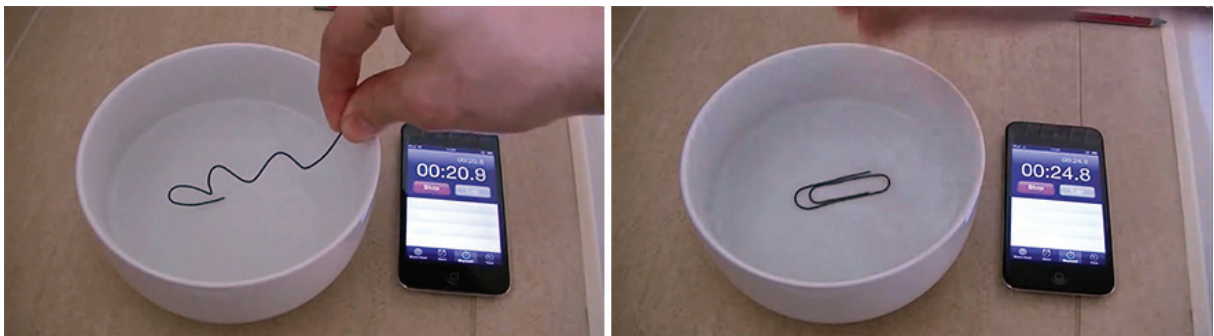
Figura 03 – Exemplo de liga de nitinol recuperando sua forma original a partir da mudança de temperatura
