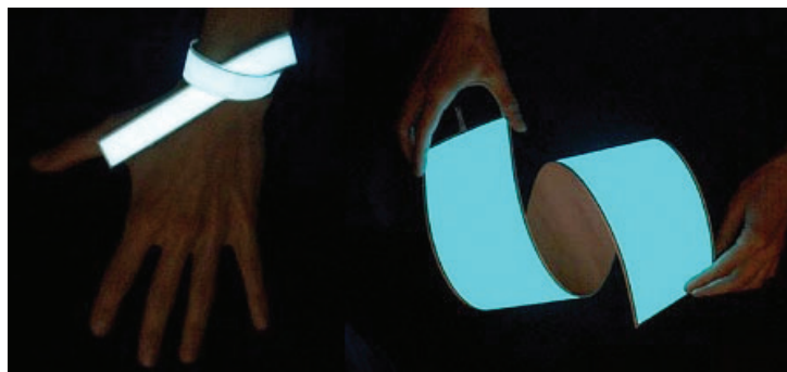
Figura 16 – Magic tape e lighting stripe – El Shine: Exemplos de OLEDs aplicados em tiras maleáveis
