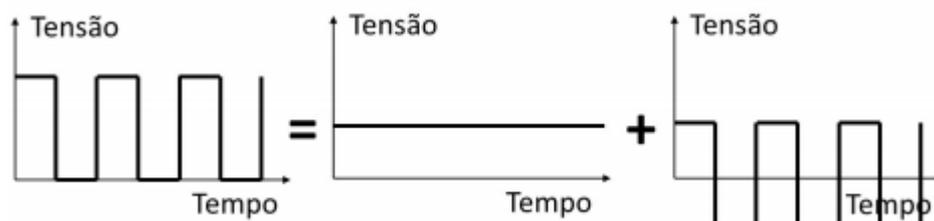
Figura 5.1: Decomposição de um sinal PWM em uma componente DC e uma onda retangular de média zero
