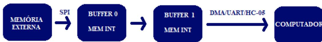
Figura 4.1: Etapas da transferência dos dados da memória externa para o computador
