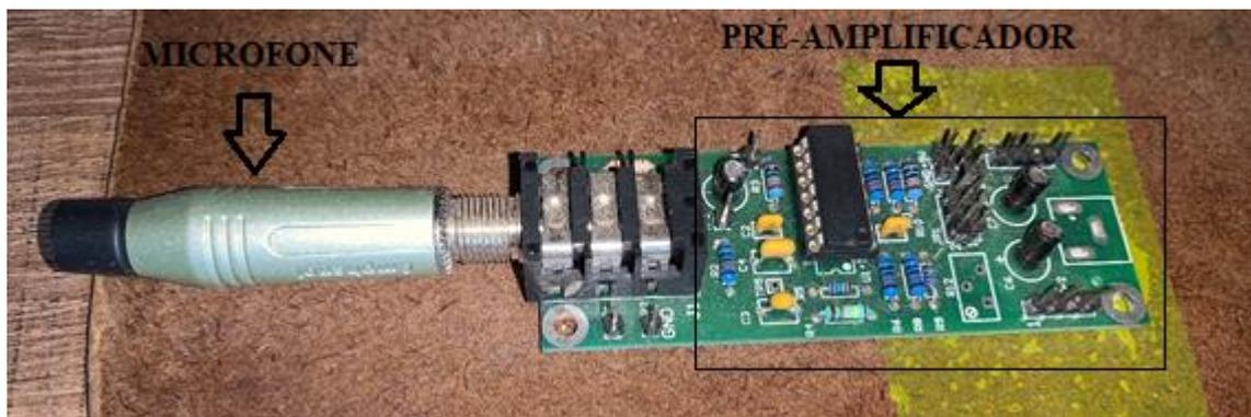
Figura 3.3: Microfone Omnidimensional e seu pré-amplificador
