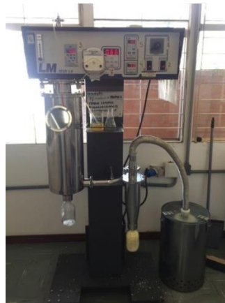
Figura 12. Spray Drying LABMAQ MSD 1,0 utilizado na atomização
