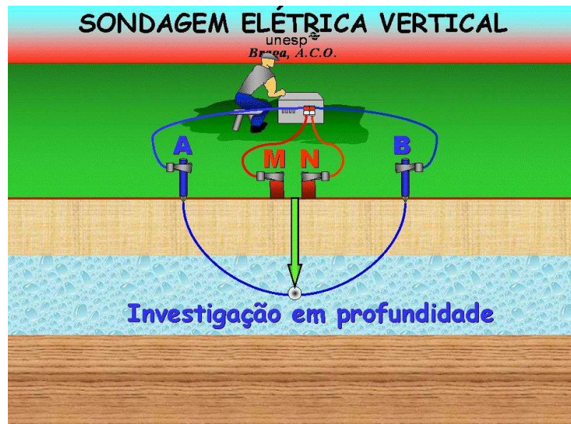
Figura 4 - Técnica da Sondagem Elétrica Vertical (SEV).
