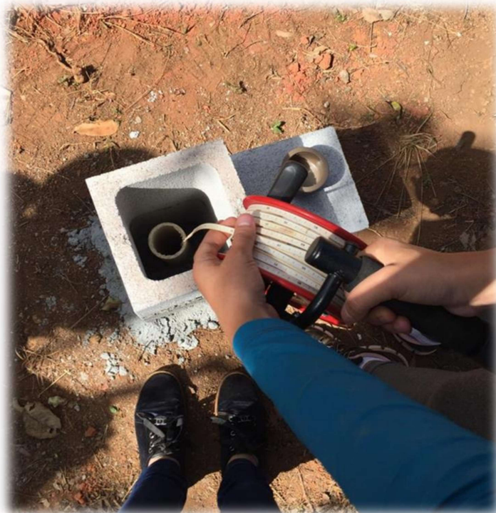
Figura 13 - Medição de profundidade de nível da água do aquífero intergranular poroso com sensor.
