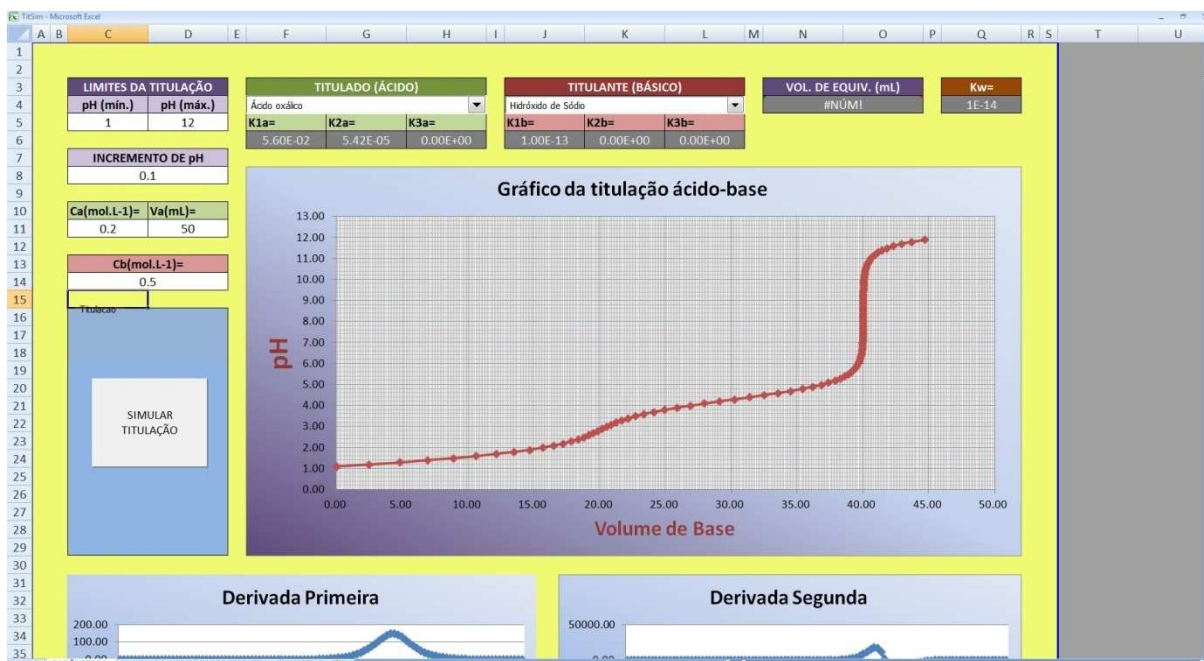
Figura 3 – Obtenção do gráfico da titulação do Ácido Oxálico com Hidróxido de Sódio
