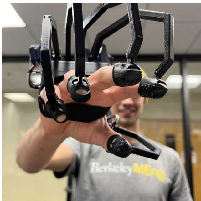
Figura 1.5: Exemplo de projeto de luva com exoesqueleto
