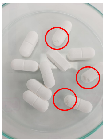
Figura 16: Lascas presentes nos comprimidos após teste de friabilidade da amostra S.1.
