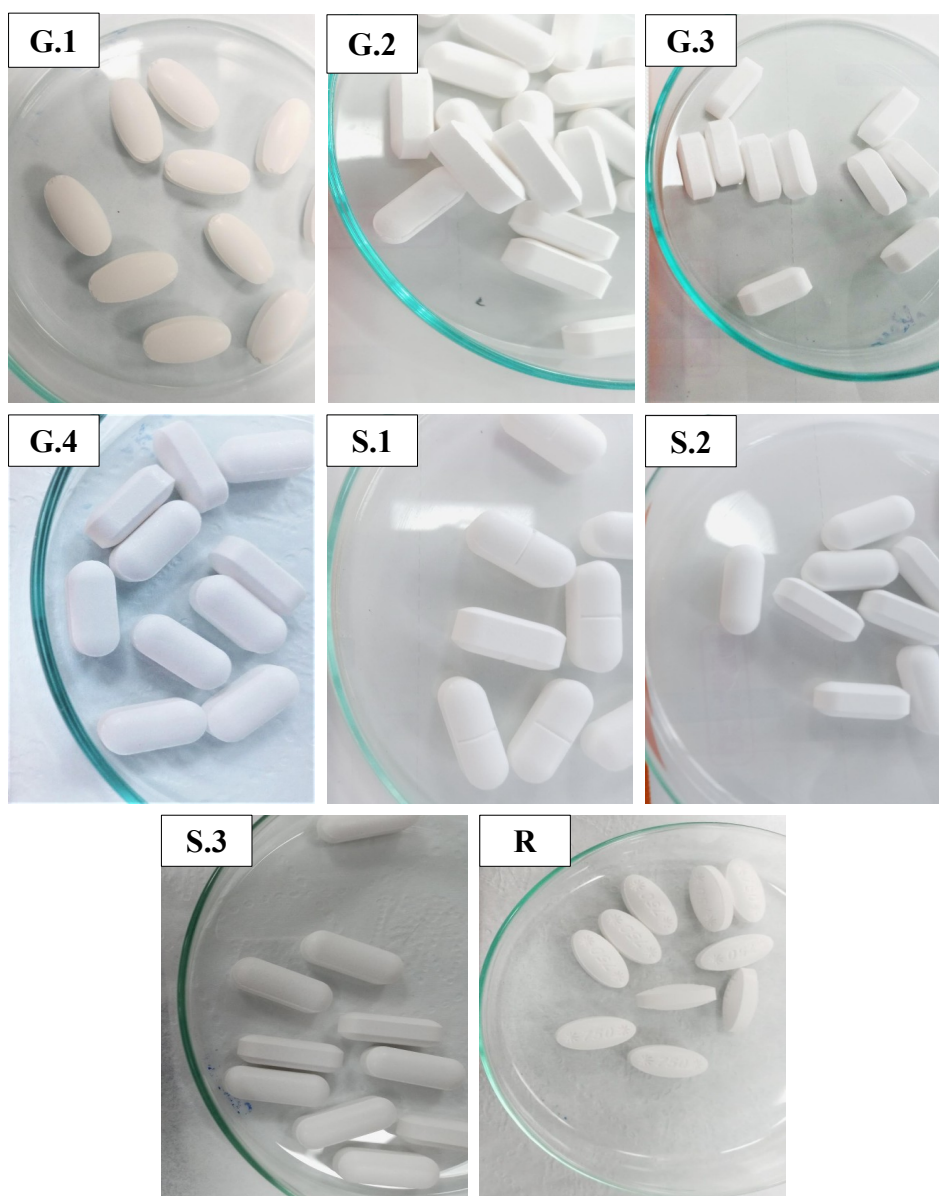
Figura 13: Aspecto visual das amostras industrializadas. Sendo as amostras G.1, G.2, G.3, S.1 e S.2 comprimidos não revestidos e as amostras G.4, S.3 e R revestidos com filme.
