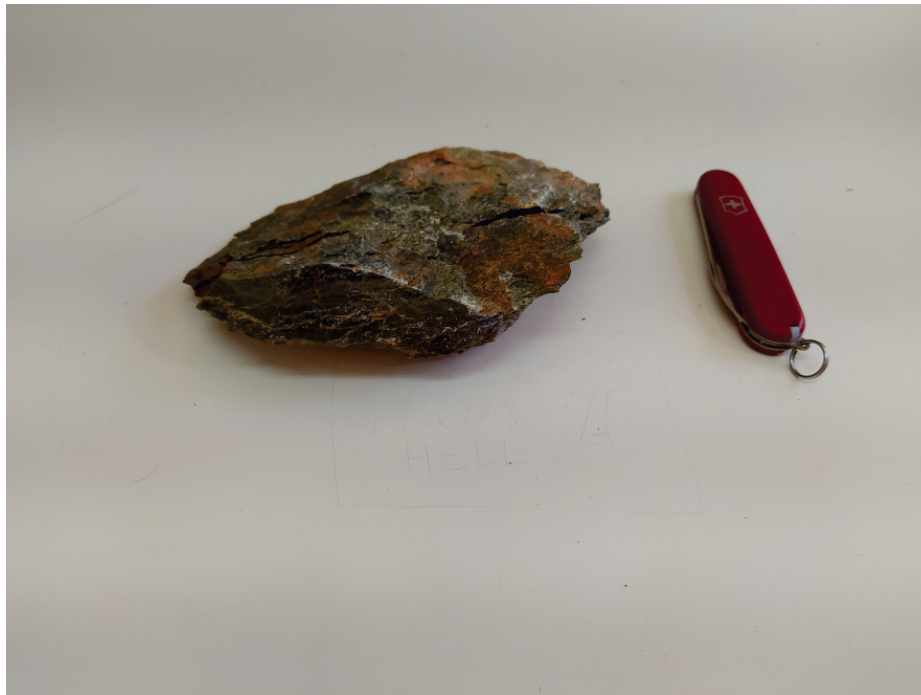
Figura 4.11: Ultramilonito com foto em sentido perpendicular à foliação.
