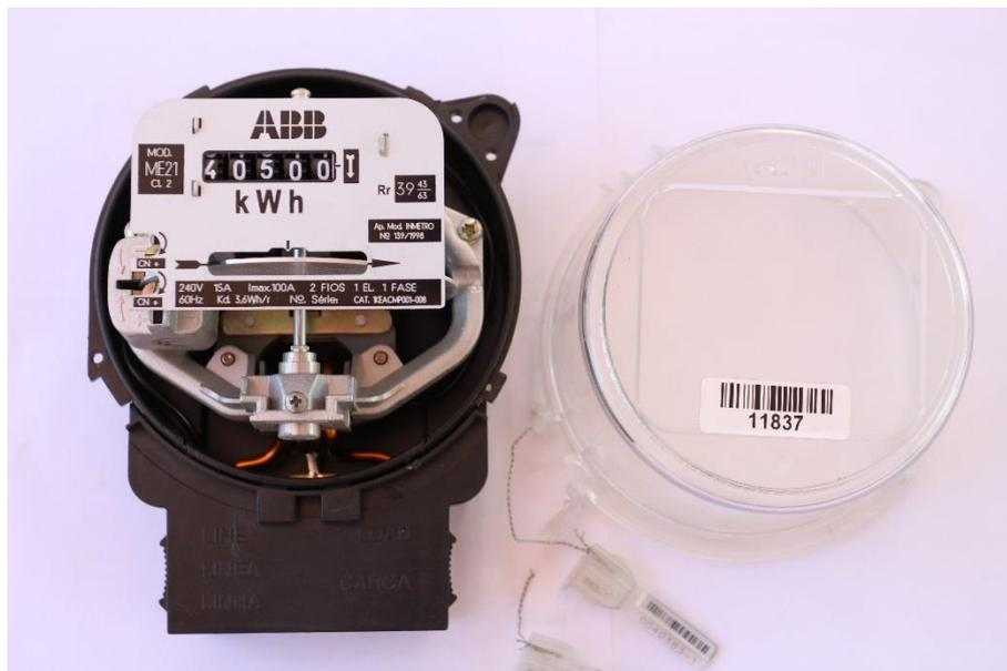
*Figura 10 - Medidor de Energia já alterado*
