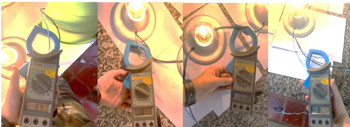
*Figura 13 - Medições de corrente em cada parte do circuito*
