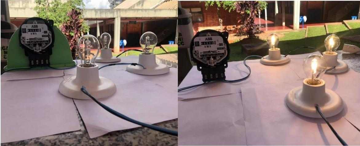
*Figura 11 - Circuitos para simulação de consumo*
