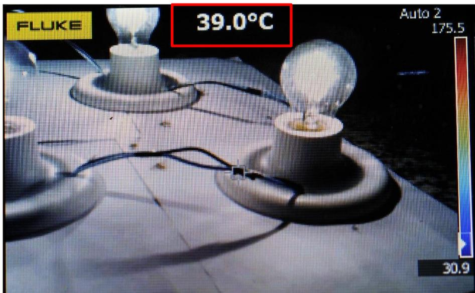
*Figura 19 - Medição Final com Efeito Joule e circuito mal dimensionado.*
