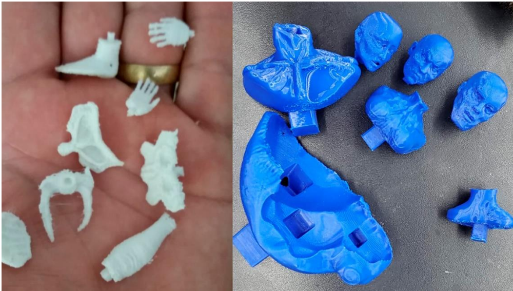
Figura 41 – Acabamento e retirada e excessos de filamento. Autor.
