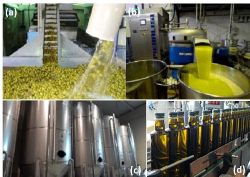
Figura 5 - Etapas do Processo de Produção do azeite. (a) Lavagem e Trituração; (b) Centrifugação; (c) Decantação; (d) Envase e Etiquetação (CHAGAS, 2021)
