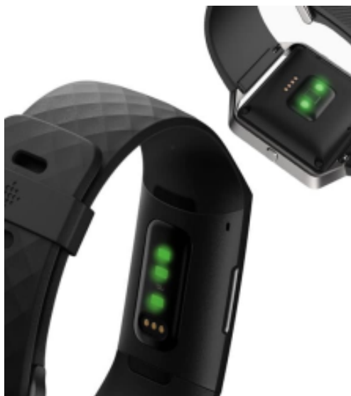
Figura 2.11: Exemplo de monitor PPG. Adaptado de [37].
