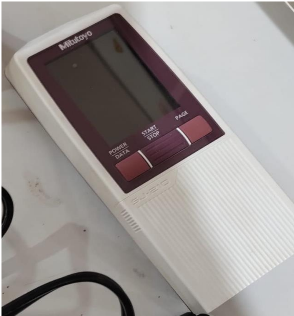
Figura 26 - Rugosímetro digital Mitutoyo SJ-210 .
