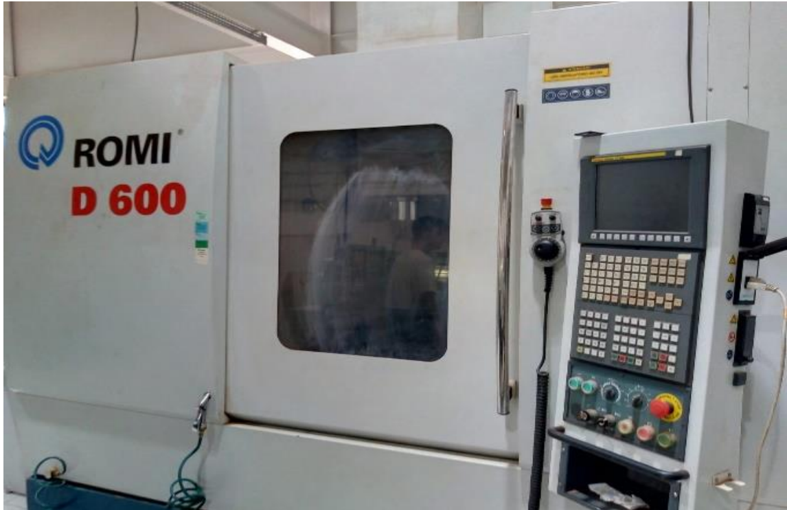
Figura 24 - Centro de usinagem CNC para realização dos testes.
