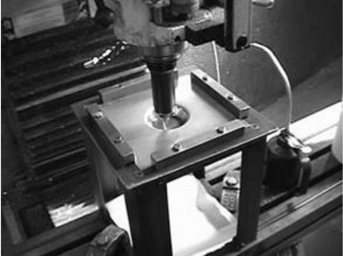
Figura 2 – Execução do processo de estampagem incremental de ponto simples.
