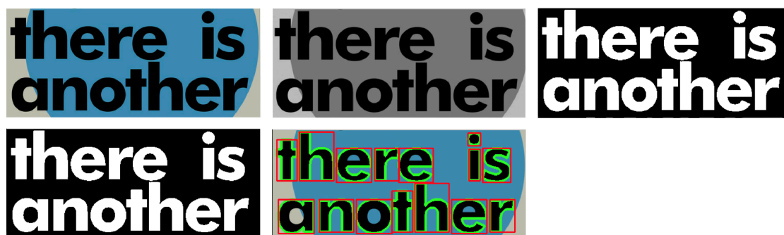
Figura 4.6: Resultado por etapa do processo de reconhecimento de caracteres em imagens do banco de imagens. i)imagem original, ii)escala de cinza, iii)binarização inversa, iv)dilatação com kernel em cruz e v)contornos e retângulos limitadores
