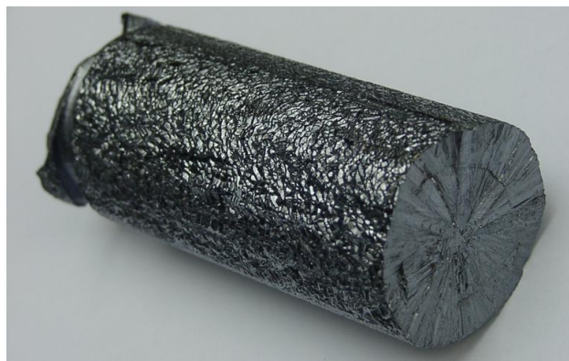
Figura 3.5: Silício Policristalino antes de ser preparado para utilização em células (Autor: Warut Roonguthai)
