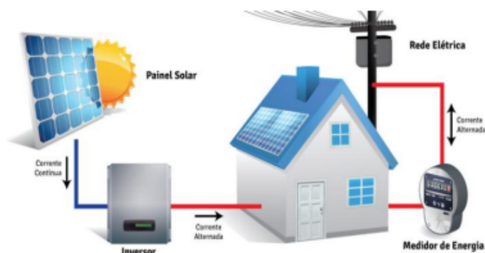
Figura 2.6: Sistema On-Grid (Fonte: [Bortoloto et al. 2017])
