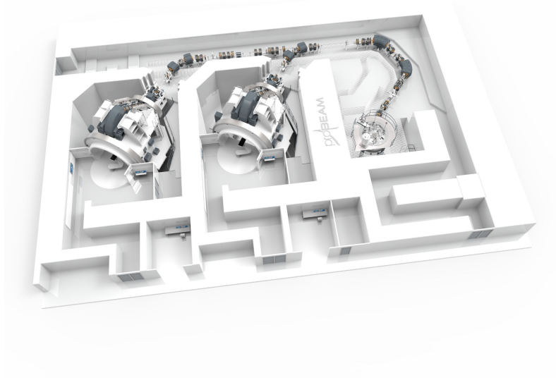
Figura 21 – Esquema de uma instalação de protonterapia com 3 salas de tratamento, que utiliza o ProBeam da Varian. À direita da imagem, é possível ver o cíclotron, de onde o feixe é extraído e direcionado até as salas de tratamento. Retirado de (VARIAN..., 2023).
