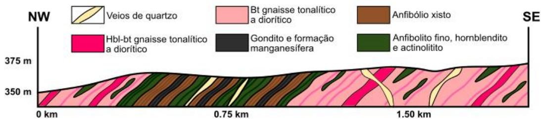
**Figura 6. 8:** Perfil esquemático demonstrando as intercalações vistas em campo.
