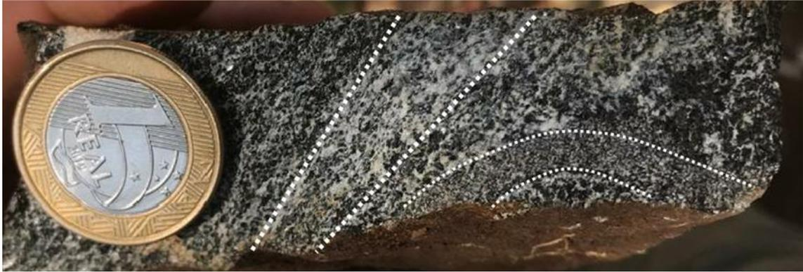
**Figura 6.7:** Amostra de hornblenda biotita tonalito gnaissé (ponto V\_14) bandado e com variação de proporção mineral e granulometria.
