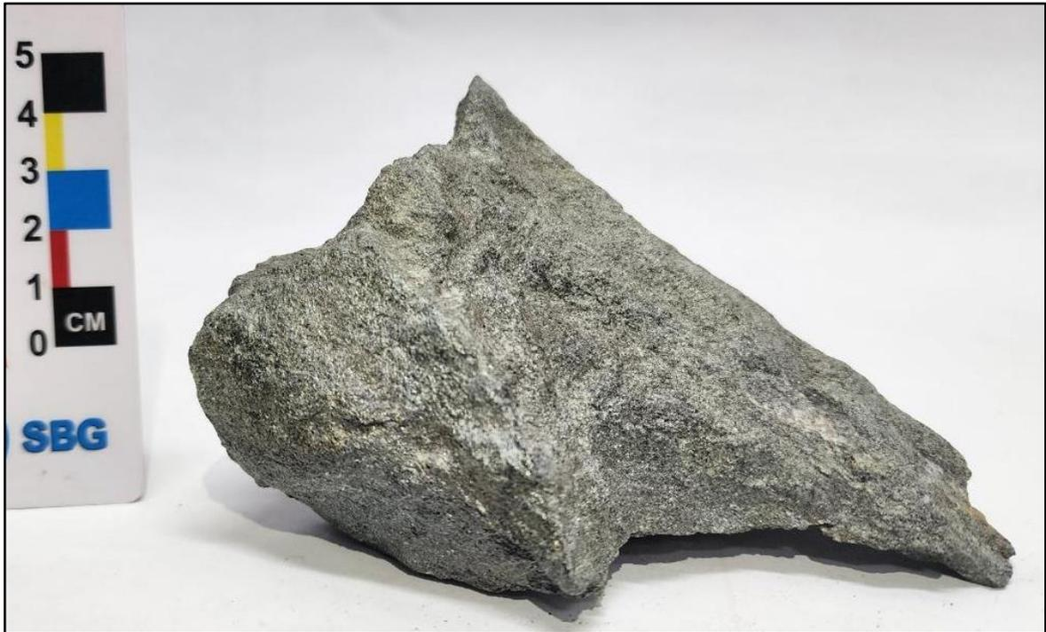
**Figura 7.5:** Amostra TF22-X-69, classificada como biotita xisto com segregações de quartzo e sulfetação associada. A rocha aflora ao longo de uma das zonas de cisalhamento N-S na Área X, caracterizando possível ocorrência mineralizada do sistema aurífero orogênico. Ainda que não seja mineralizada, atua como importante vetor prospectivo.
