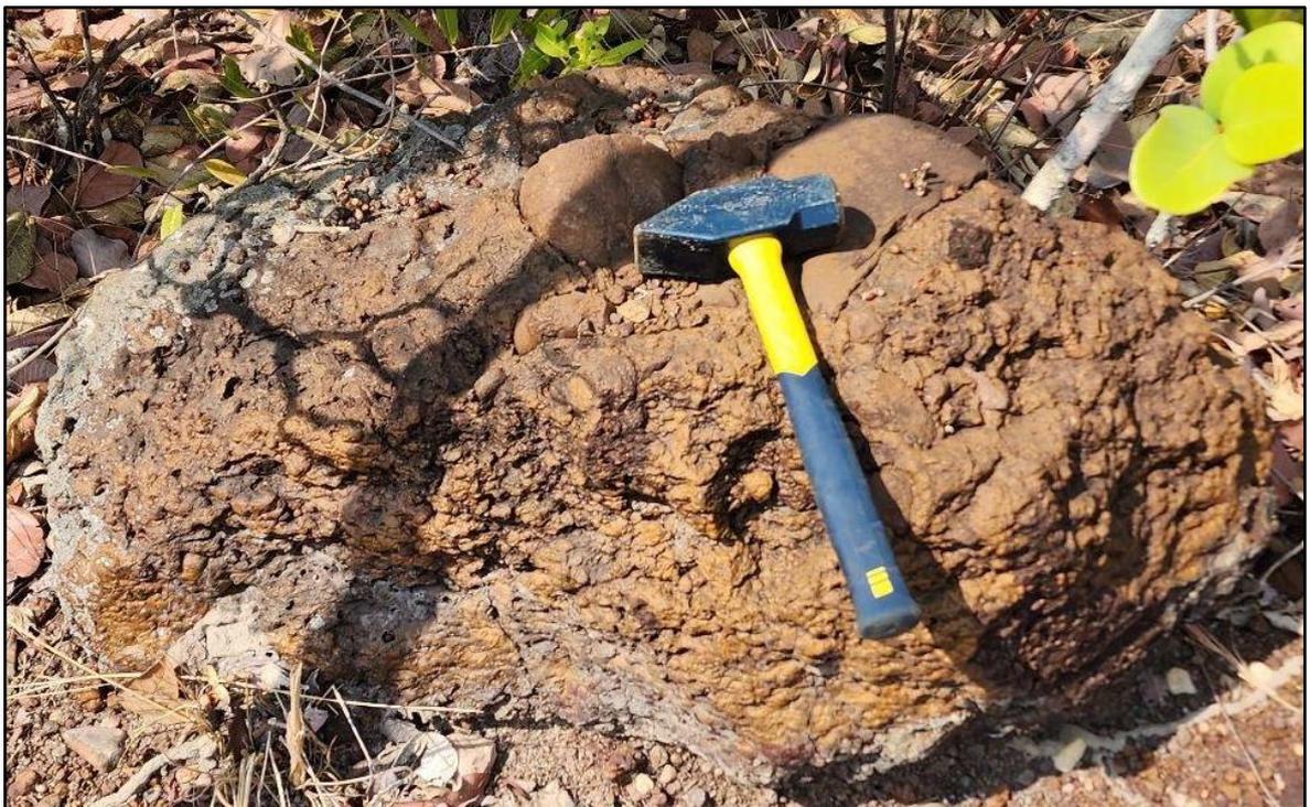
**Figura 7.7:** Exemplo de concreção laterítica, recorrente ao longo da Área X, aflorando amplamente em platô na porção leste da área.
