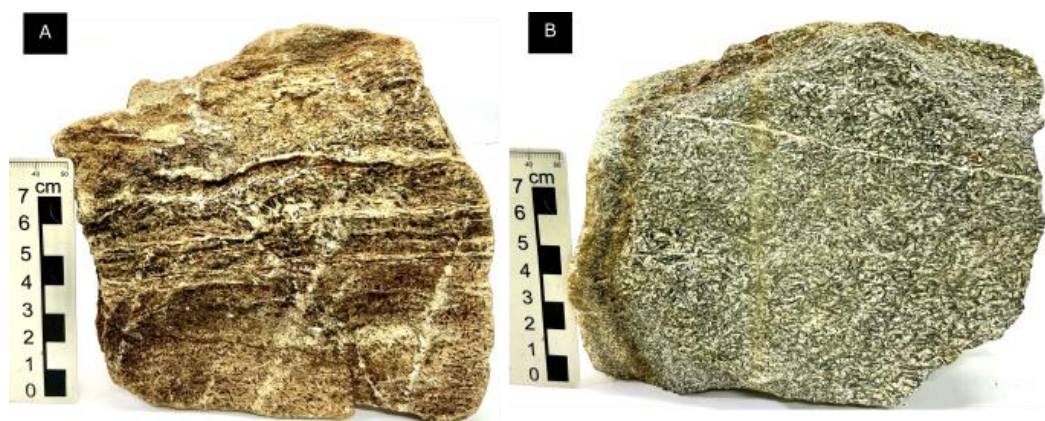
Figura 5.2: (A) amostra retirada do ponto 138 explicitando bandamento, mesmo que os minerais prismáticos tenham comportamento diblástico, há uma alternância de domínios composicionais. Há venulações com cristais de muscovita que intersectam a foliação. (B) amostra retirada do ponto 85, a qual explicita o caráter diblástico por parte dos cristais de actinolita dispersos em matriz de plagioclásio e quartzo.
