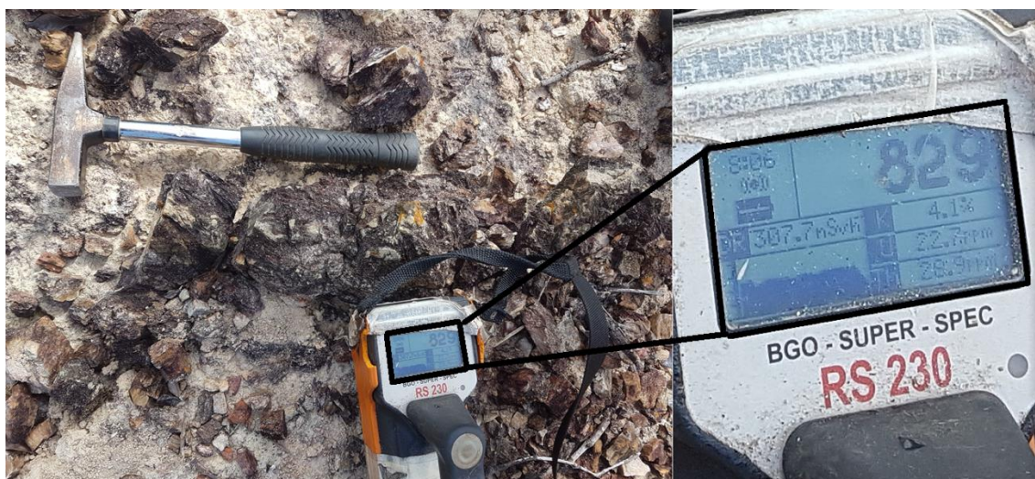
Figura 4-7 – Afloramento de sillimanita xisto, evidenciando anomalia radiométrica. Com o auxílio de um gamaespectrômetro foi possível localizar o ponto anômalo onde foi encontrado o sillimanita xisto.
