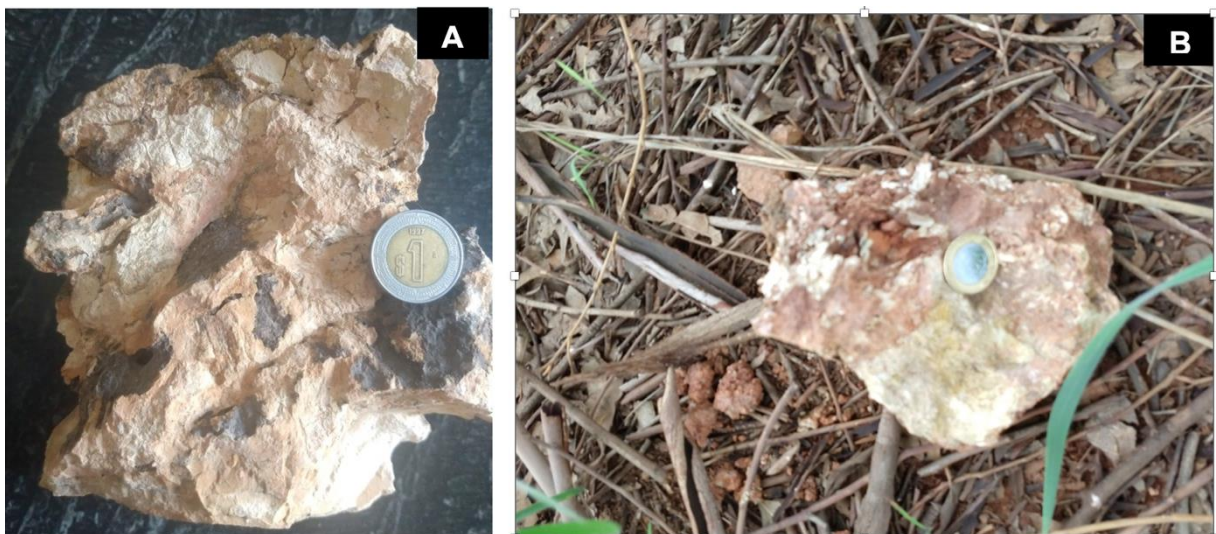
Figura 20: Amostras mesoscópica da brecha fosforítica. Em "A" A brecha fosforítica laminada sendo uma fácies amorfa. Em "B", brecha fosforítica com matriz síltica de colofana
