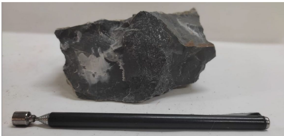
Figura 4.19: Amostra de dololutito maciço. Domínios esbranquiçados são formados pela recristalização do próprio material carbonático
