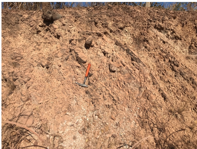
Figura 4.3: Ritmito pelítico, caracterizado pela intercalação de pacotes de siltitos, entre 15 e 70 cm, e níveis psamíticos entre 10 e 20 cm. Ponto 96, Coordenadas UTM: Zona 23 S, N 8.143.859, E 300.714.
