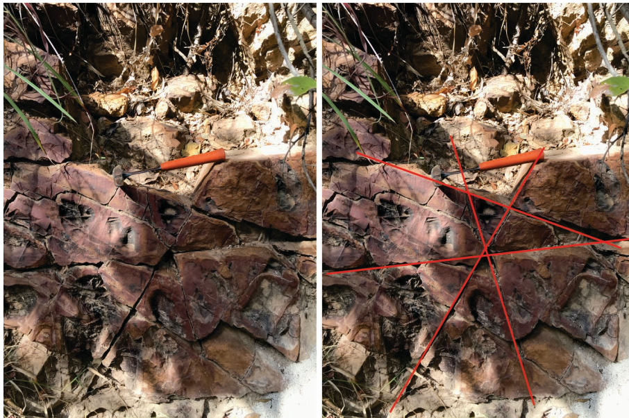
Figura 6.4: Afloramento em drenagem de ritmito psamo-pelítico. Na foto tem-se uma camada psamítica, classificada como grauavaca, bem alterada, que mostra um sistema de fraturas. Ponto 114, coordenadas UTM: Zona 23 S, N 8.146.907, E 298.543.
