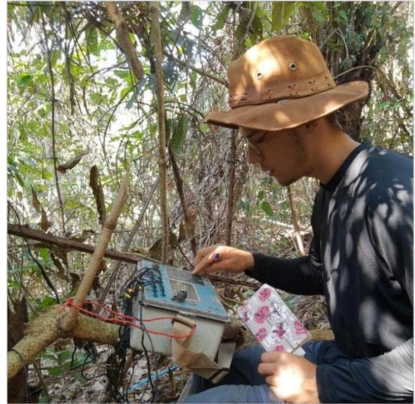
Figura 5-4. Operação do Elrec Pro na aquisição do método IP
