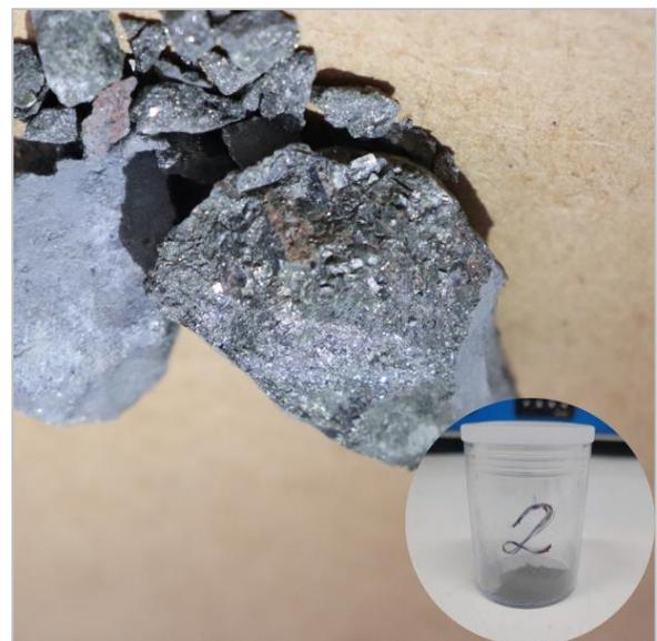
Figura 5-6. Fragmento de veio mineralizado com sulfetos da cava de minérios (Área A) [Furo 02, 50.35m]
