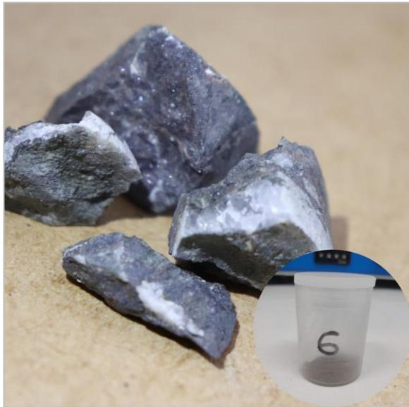
Figura 5-7. Fragmento de veio mineralizado com alto teor de zinco (Área B) [Furo 18, 74.90 m]
