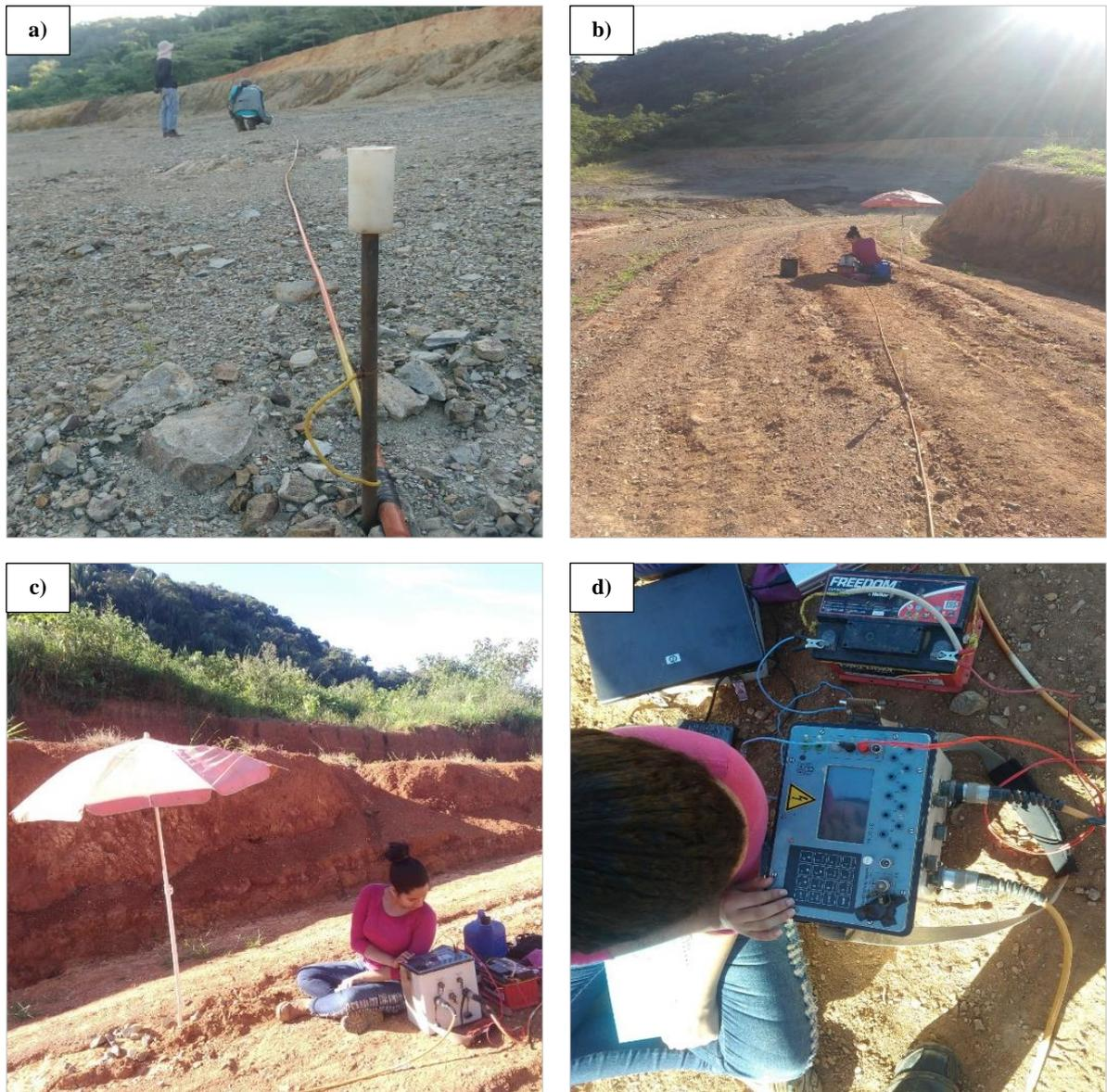
Figura 4-2. a) eletrodo de ferro aterrado e conectado ao cabo multieletródico; b) estação de controle de qualidade dos dados durante a aquisição; c) equipamentos utilizados na estação de controle de qualidade dos dados; d) eletrorresistímetro conectado à cabo multieletródico, bateria 12 V, inversor e computador da estação de controle de qualidade dos dados
