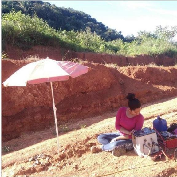
Figura 5-3. Operação do Syscal Pro na aquisição do método ER
