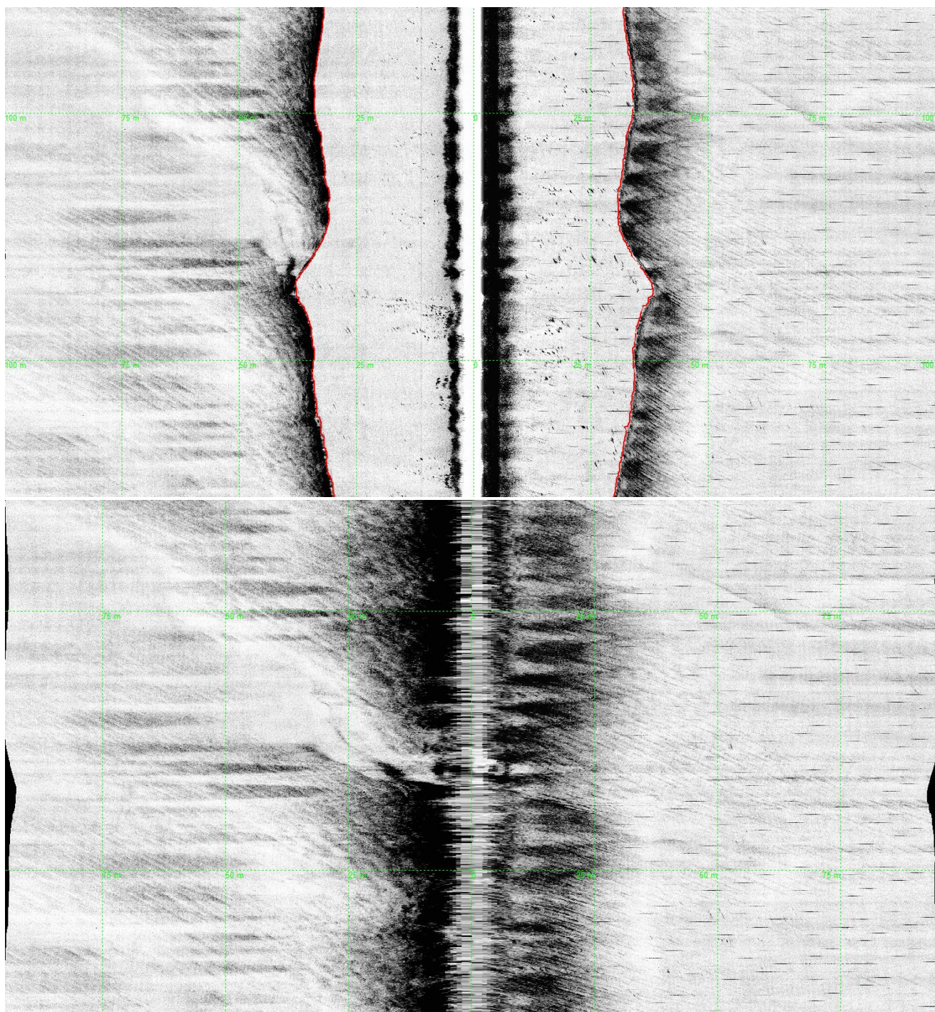
Figura 23 - Seção da linha L14012 do Sonar de Varredura Lateral. a) slant correct desativado, b) slant correct ativado.
