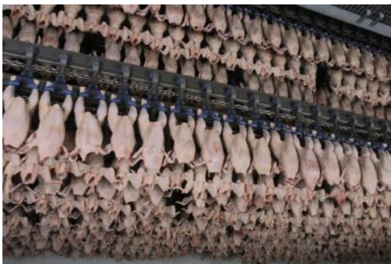
Figura 7. Visão geral da área de refrigeração no sistema de resfriamento pelo uso de correntes de ar.
