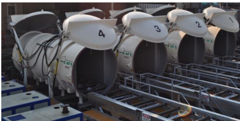
Figura 6. Cilindros de Descompressão - Método de Insensibilização de Baixa Pressão Atmosférica
