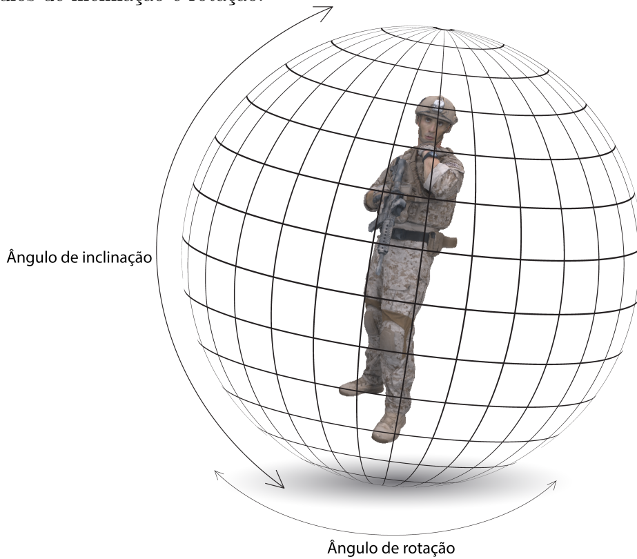
Figura 3.4: Representação de nuvem de pontos contida na casca esférica e respectivos ângulos de inclinação e rotação.
