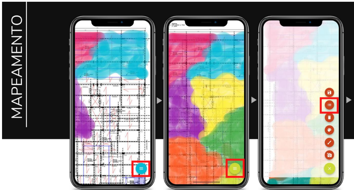
Figura 5.34 – Telas de delimitação de áreas de concreto onde cada cor representa um caminhão (autoria própria, 2022)
