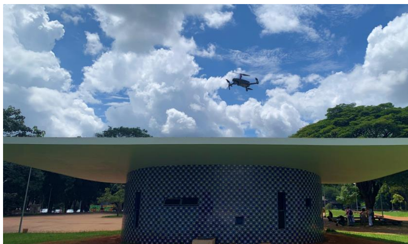
Figura 5.44 Drone empregado para o levantamento por aerofotogrametria. Fonte: Autor.
