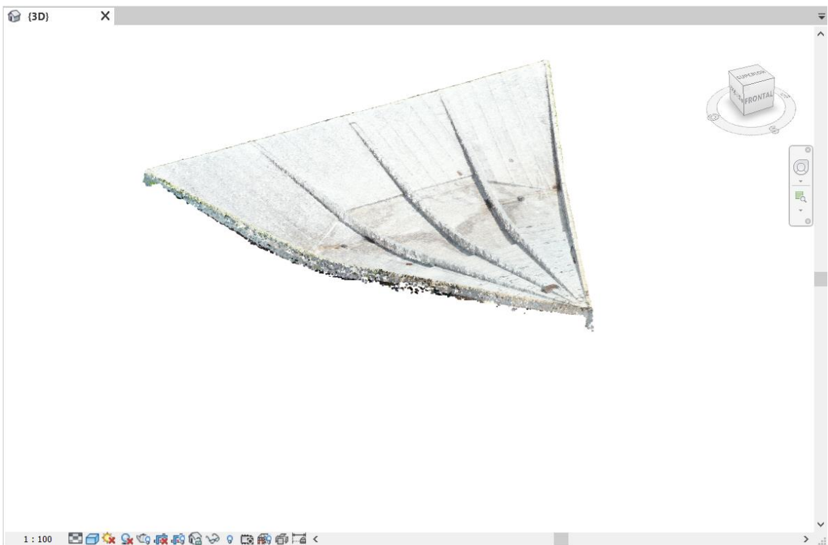
Figura 5.46 Nuvem de pontos por aerofotogrametria importada para o Revit. Fonte: Autor.
