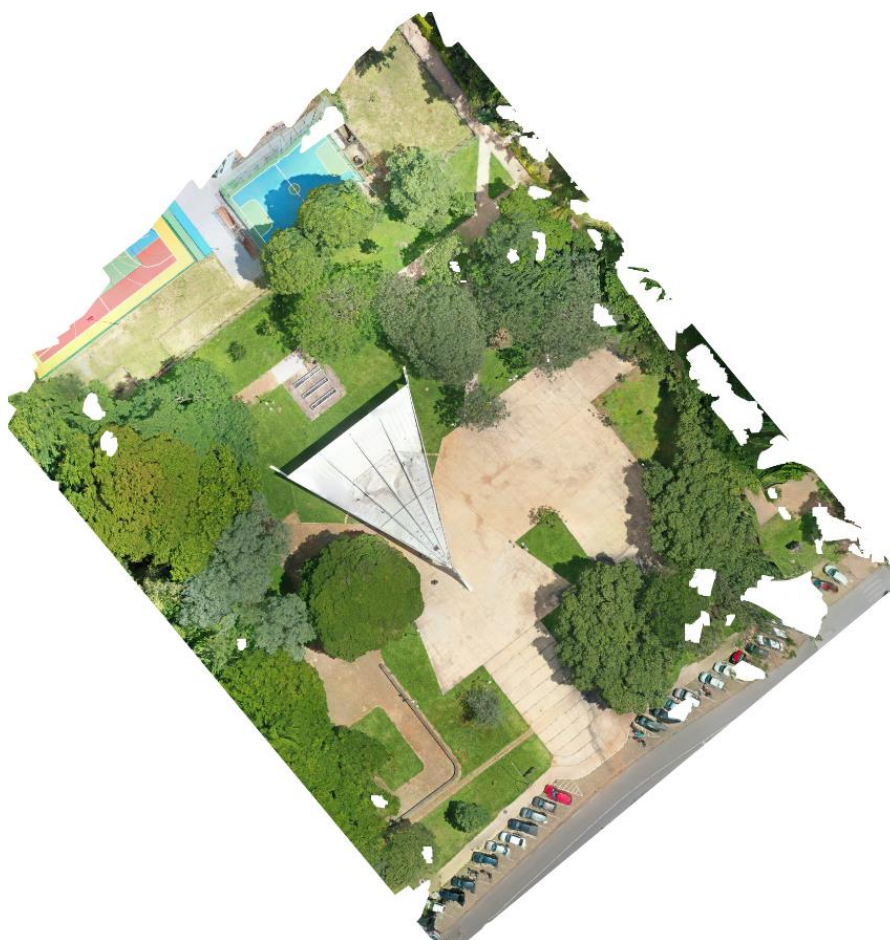
Figura 5.43 Ortomosaico do levantamento da Igreja por aerofotogrametria. Fonte: Autor.
