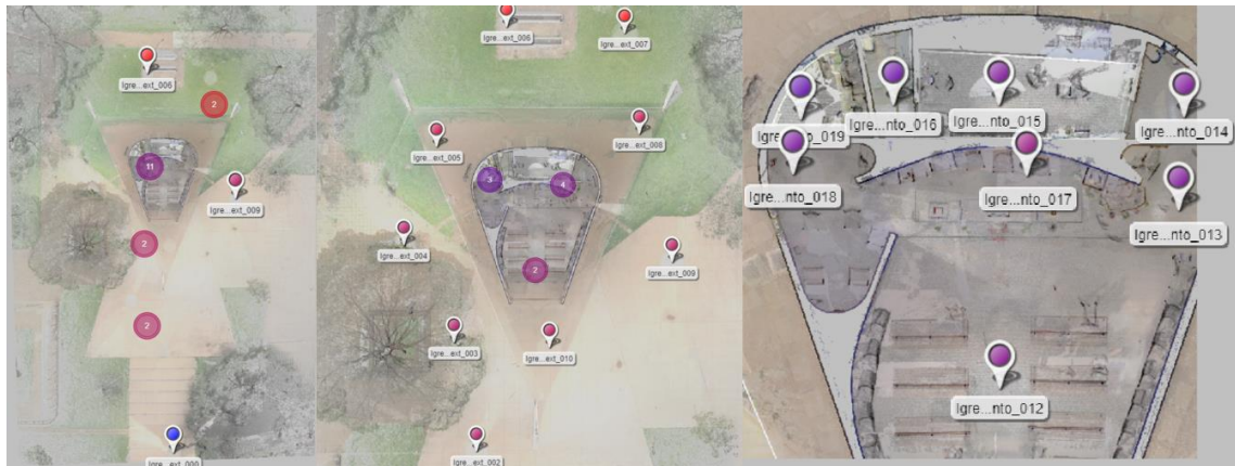
Figura 5.41 Locais de posicionamento do equipamento para varredura completa da edificação. Fonte: Autor, Grupo Flug.
