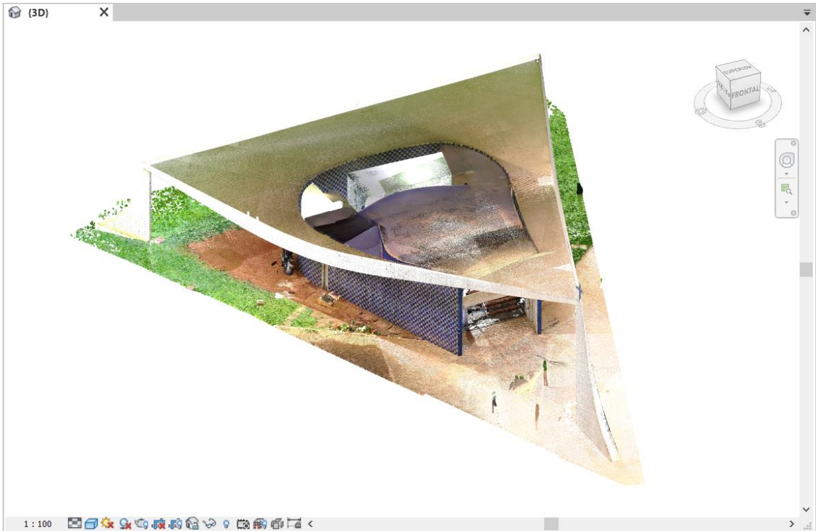
Figura 5.45 Nuvem de pontos por escaneamento a laser terrestre importada para o Revit. Fonte: Autor.
