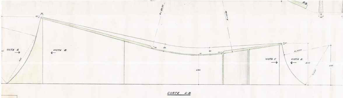
Figura 5.3. Corte longitudinal da estrutura da Igreja Nossa Senhora de Fátima. Fonte: Arquivo Público do Distrito Federal, 2022.
