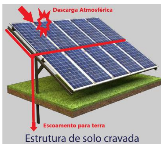
Figura 3.13: Estrutura de fixação em solo cravada
