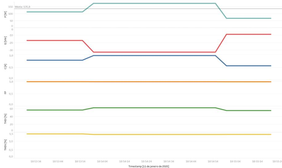
Figura 19 – Medição de potência ativa, potência reativa, corrente, fator de potência, total de distorção harmônica de tensão e corrente no período de 2 minutos com apenas o liquidificador ligado.
