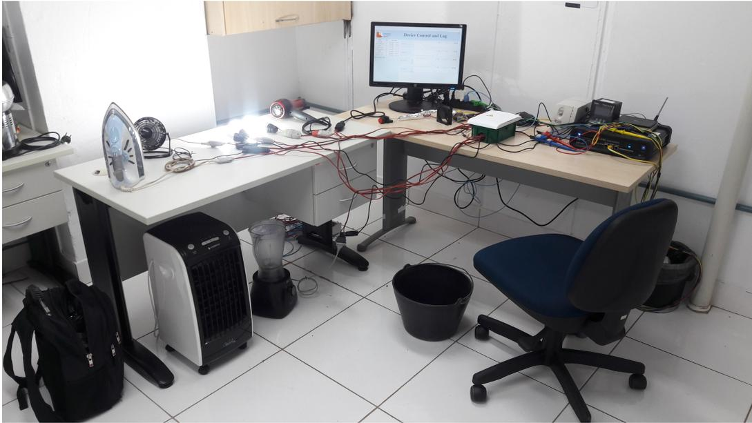
Figura 6 – Bancada de coleta de dados. Sob e sobre a mesa esquerda encontra-se sete dos oito eletrodomésticos utilizados e sobre a mesa da direita estão o monitor, como último eletrodoméstico, no canto esquerdo e os dois medidores utilizados no canto direito. No centro da mesa da direita encontra-se o quadro de força do experimento.
