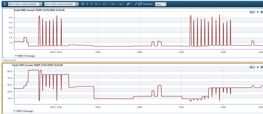
Figura 8 – Apresentação de dados amostrados a cada segundo no software PQS Sapphire.
