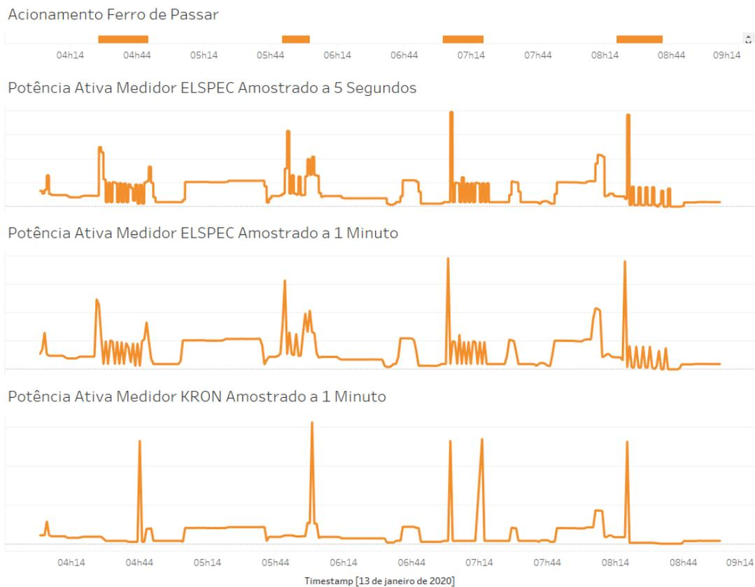
Figura 25 – Medição de potência ativa com dois medidores de qualidades distintas e amostragens distintas.
