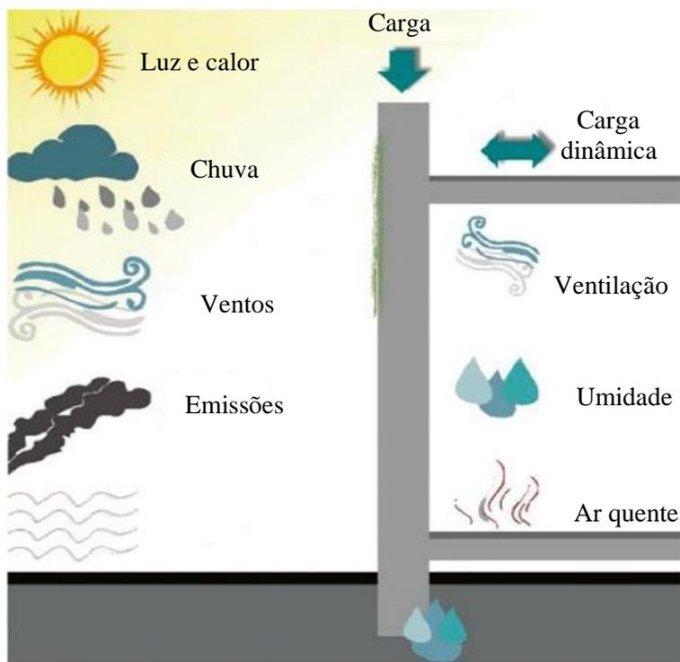
Figura 1 – Solicitações em sistema de vedação vertical (Kazmierczak *et al.*, 2016)
