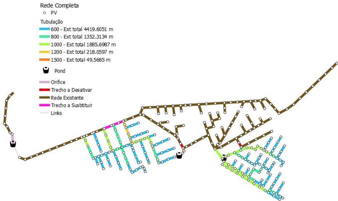
Figura 5.18 Rede completa após simulação e dimensionamento
