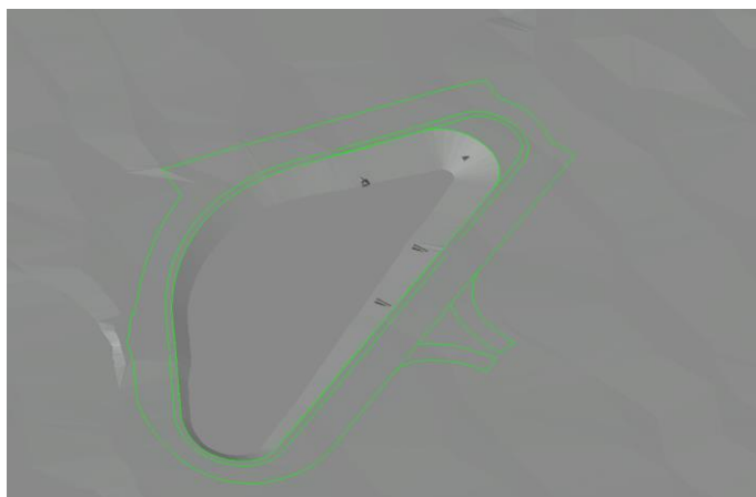
Figura 5.11 – Modelagem em 3D da bacia na rotatória da DF480
