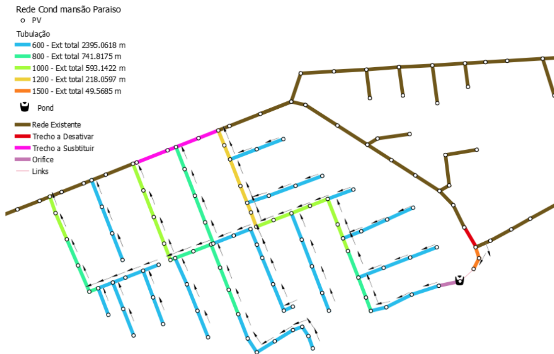
Figura 5.17 Rede Cond. Mansão Paraíso após simulação e dimensionamento
