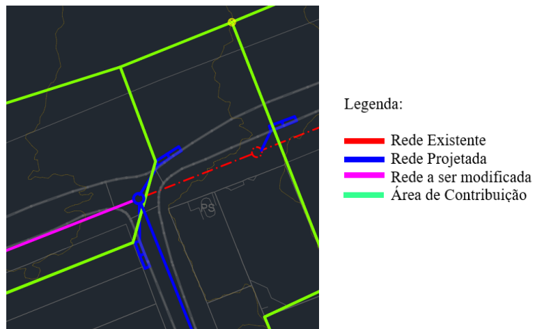
Figura 4.23 Estilo - Pipe network
