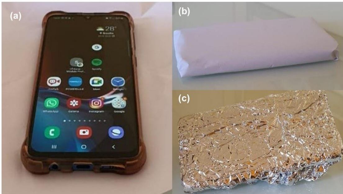
Figura 4- Prática experimental, (a) celular utilizado no experimento; (b) celular envolvido na folha de papel e (c) celular envolvido na folha de alumínio.
