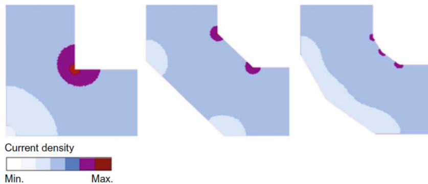
Figura 15 – Densidade de corrente em diferentes angulações de corners : à esquerda 90°, no meio 135° e à direita 150°
