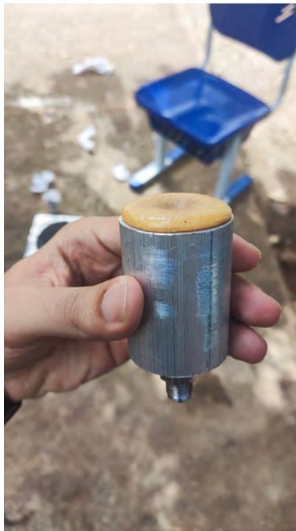
Figura 4.6: Rocket candy colocado na cavidade do injetor.
