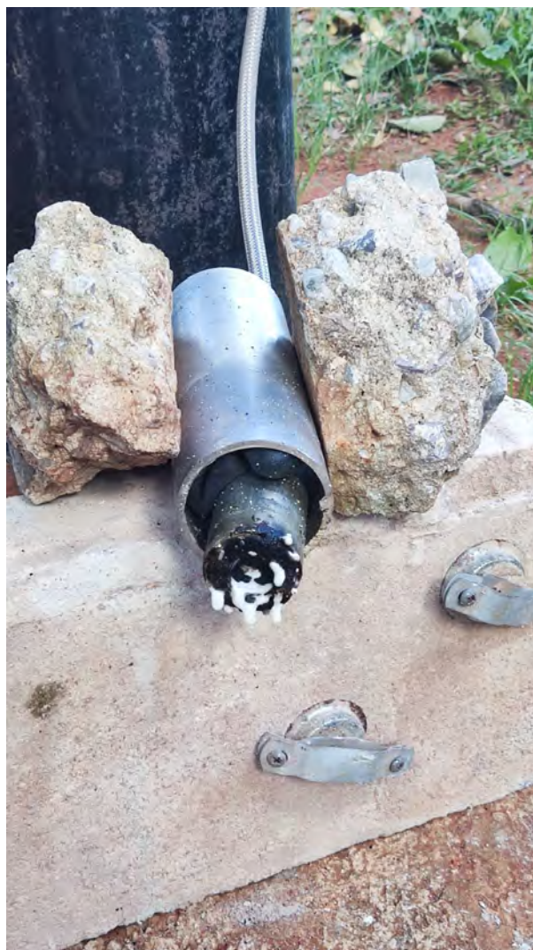
Figura 4.10: Injetor após a queima completa do rocket candy .
