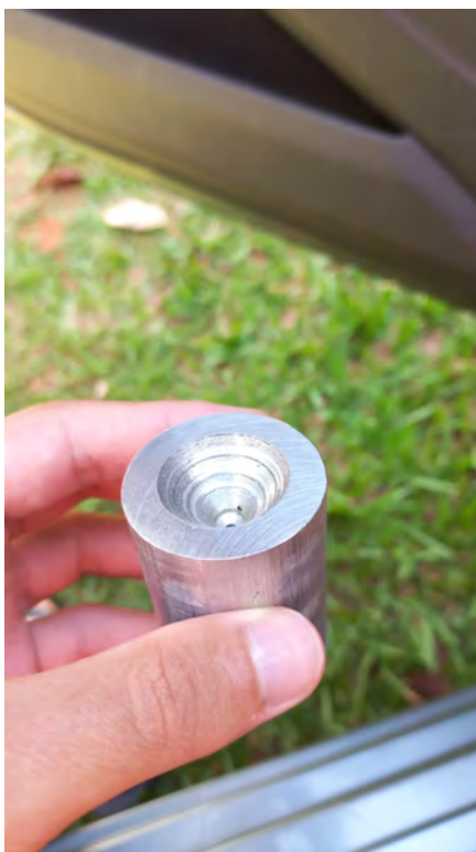
Figura 4.1: Injetor de teste fabricado, sem anel soldado.
