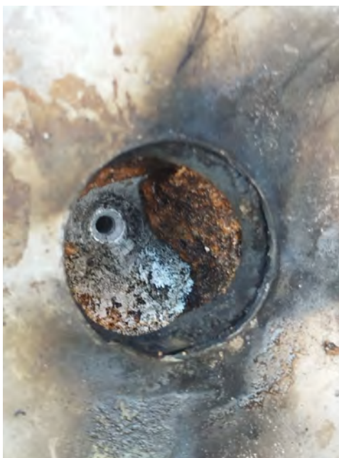
Figura 6.25: Cavidade do rocket candy após a queima.
