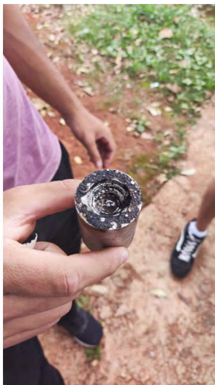
Figura 4.7: Injetor após a ignição do rocket candy .
