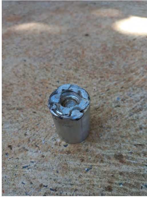
Figura 4.8: Injetor com anel de alumínio soldado.
