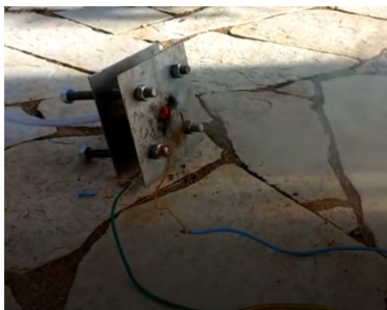
Figura 6.19: Final da queima do rocket candy e desobstrução do canal injetor.
