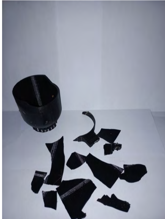
Figura 6.27: Corpo de prova 14 com falha entre as camadas.
