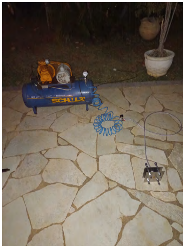
Figura 6.13: Experimento de até 8 bar montado, sem o skib.
