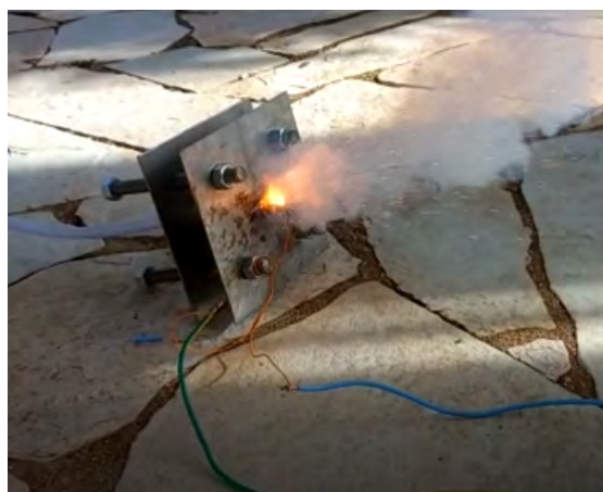
Figura 6.16: Ignição do skib.
