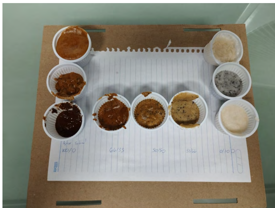
Figura 6.1: Misturas para teste de queima do Rocket Candy
