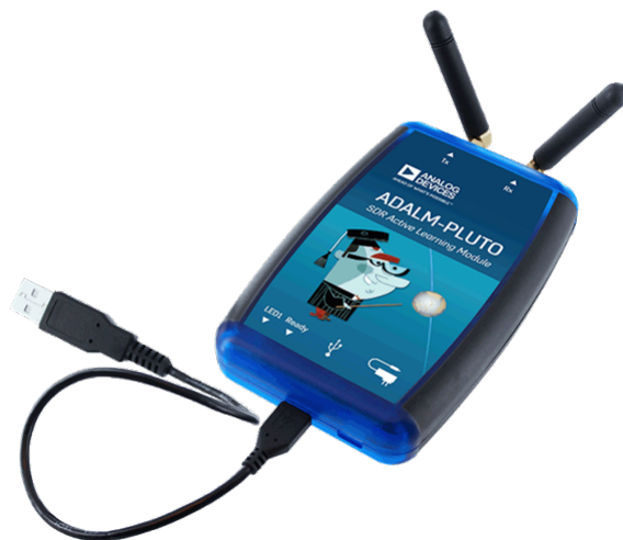
Figura 3.2. ADALM-PLUTO AD9363. Rádio definido por software voltado para o aprendizado de fundamentos de SDR [7].
