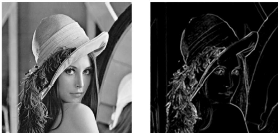
Figura 16 – Comparação entre imagem original e imagem filtrada. Fonte: (GUO; XU; CHAI, 2010).
