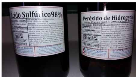
Figura 4 – Ácido Sulfúrico e Peróxido de Hidrogênio Utilizados na Etapa de Síntese Química de Grafite em Pó. Fonte:Autores
