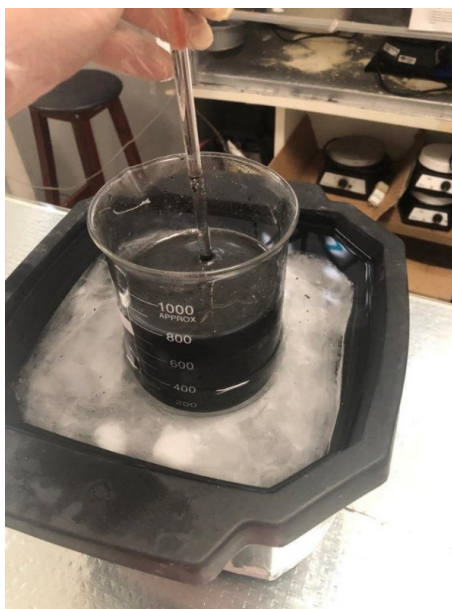
Figura 5 – Óxido de grafite no banho de gelo para não ultrapassar 30^\circ C .Fonte:Autores
