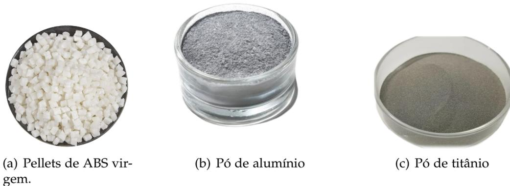
**Figura 7** – *Materiais utilizados na produção dos filamentos.*
