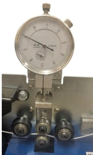
**Figura 24** – Filamento de ABS-alumínio com 1,79mm de diâmetro.
