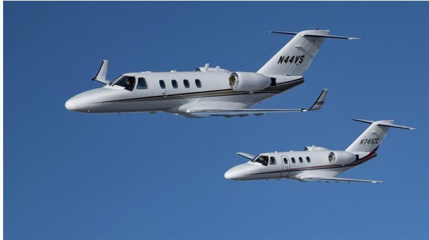
Figura 1 – Cessna 525 em sua configuração normal (abaixo) e com a instalação de Winglets (Acima) (GROUP, 2021)
