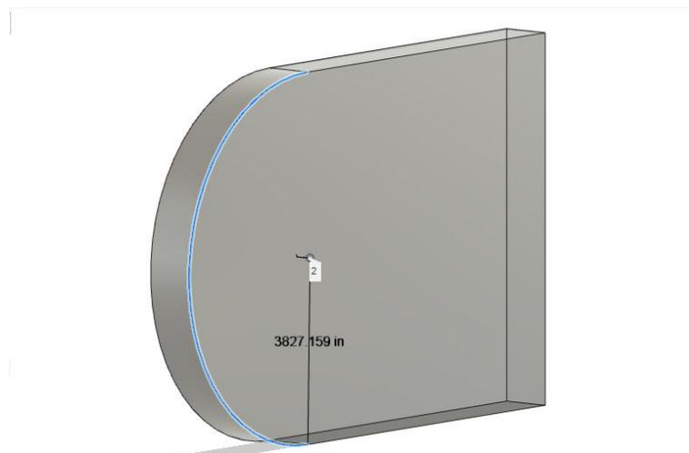
Figura 19 – Dimensão do raio do "Inlet" do Volume de Controle
