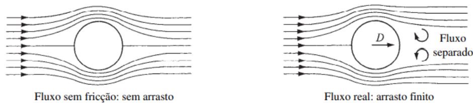
Figura 2 – Comparação entre fluxo ideal sem fricção e fluxo real com os efeitos da fricção (JR, 2015)
