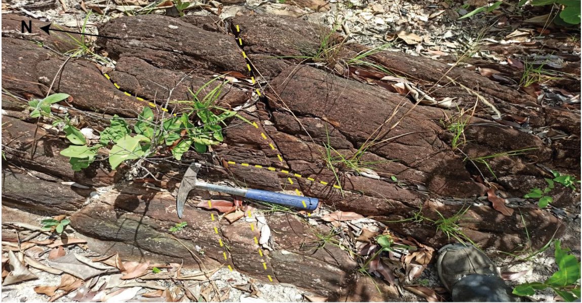
Figura 5.9. Par de fraturas conjugadas em Meta Quartzite Arenitos (Ponto 135).
