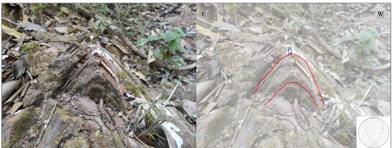
Figura 5. 6 - Dobra fechada assimétrica em grauvaça lítica, ponto 20-XIV-19. As atitudes dos flancos medidos foram 245^{\circ}/54^{\circ} e 116^{\circ}/48^{\circ} , com caimento da linha de charneira 174^{\circ}/21^{\circ} .
