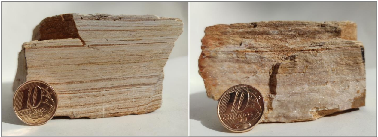
Figura 4. 29 - Amostra macroscópica 20-XIV-29, com a laminação bem marcada pela diferença nas cores.
