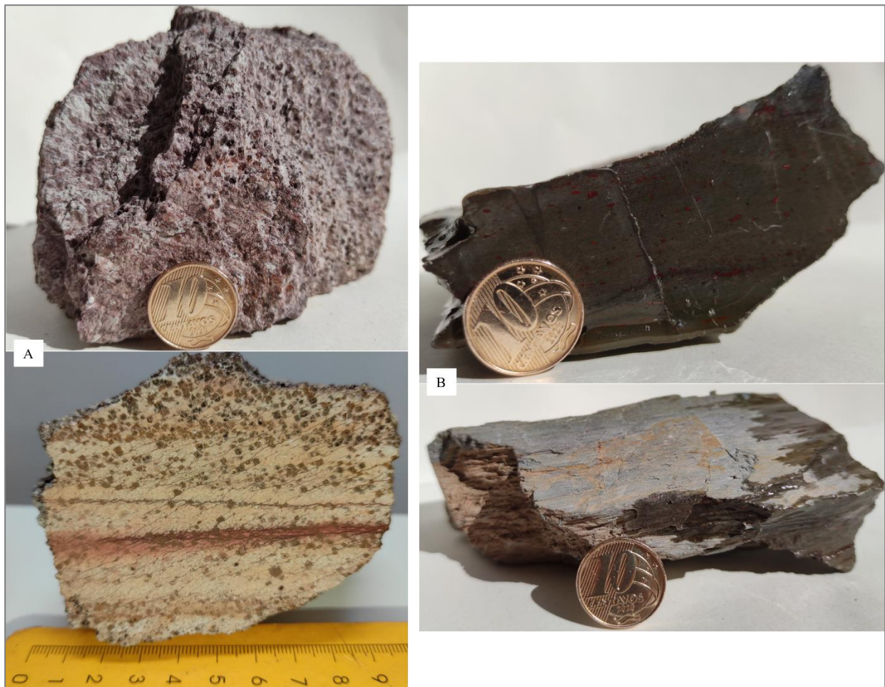
Figura 4. 25 - A) Amostra 20-XIV-P28 macroscópica, em que é possível observar na porção serrada a relação entre o acamamento e a foliação principal, marcada pelos óxidos e pseudomorfos como porfiroblastos (292628 L/ 8134788 S). B) Amostra 20-XIII-P33 macroscópica de coloração cinza clara, com secção serrada evidenciando os pontos de óxidos e alguns porfiroblastos esbranquiçados (291812 L/ 8138942 S).
