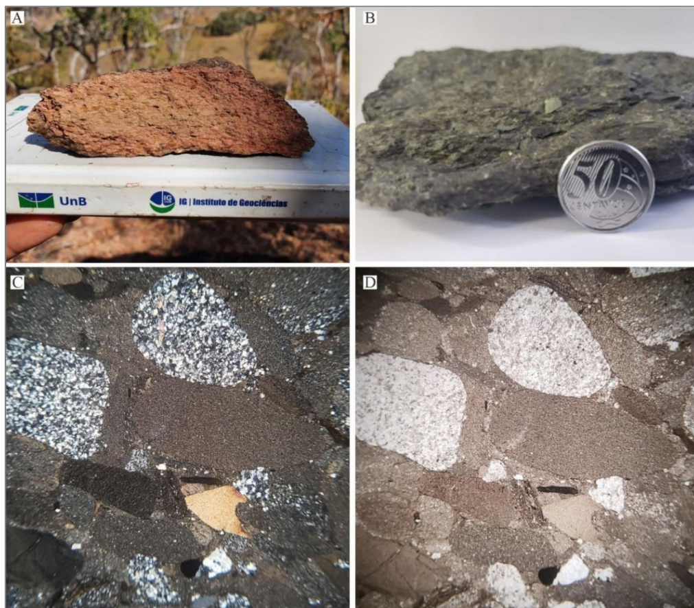
Figura 4.5 - Fácies Conglomerado maciço, Formação Quilombo. A) Amostra alterada da fácies Cm. B) Amostra da Fácies Cm. C) Lâmina petrográfica nicóis cruzados. D) Lâmina petrográfica nicóis paralelos.
