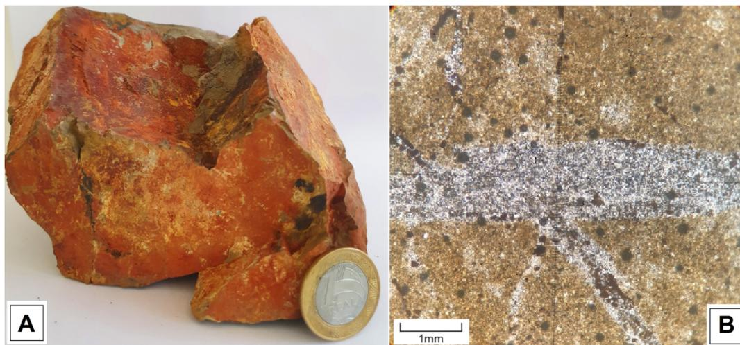
**Figura 4.18:** Amostra de mão utilizada para laminação (TF 20-IV-16), com alterações gerando cores avermelhadas e amareladas. B e C - Microfotografias mostrando esferulitos e matriz afanítica, com alteração elevada. Lente de 25x de aumento.
