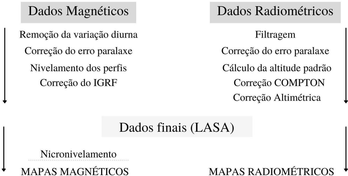
**Figura 3.6:** Sequência de processamento dos dados aerogeofísicos presentes no relatório.
