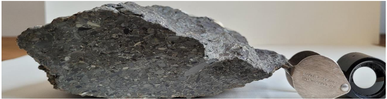
Figura 4.7 - Amostra macroscópica 20-IX-99, ortoconglomerado polimítico de coloração acinzentada, apresentando clastos arredondados com baixa esfericidade e baixo grau de selecionamento.
