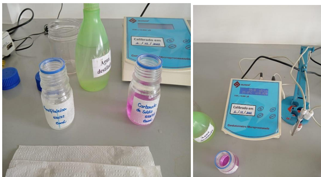
Figura 6: Teste de pH de exsudato pelo método colorimétrico aplicado em sementes de Licania tomentosa . À esquerda, as soluções indicadoras utilizadas; e à direita, o condutivímetro de bancada. Fonte: Autoral 2023).
