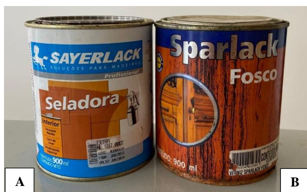
Figura 3 – Produtos utilizados para o acabamento da madeira. A – Seladora. B – Verniz fosco.
