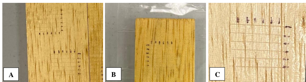
Figura 5 – Etapas do ensaio de aderência. A – Cortes em grade. B – Colagem da fita adesiva. C – Análise do destacamento com o auxílio de lupa.
