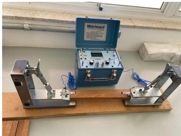
Figura 3. Equipamento Stress Wave Timer modelo 239A da Metriguard com a amostra posicionada para a medição.
